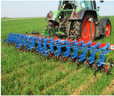
HABIHT - Montaje trasero guiado por cámara y desplazamiento lateral en cereal
