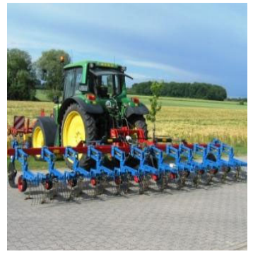
HABIHT 11 hileras guiado por cámara para col. De 2 a 18 hileras Distancia de 45 a 120 cm Montaje frontal, trasero y entre ejes
