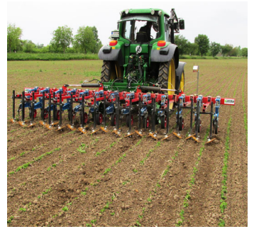
HABIHT - Montaje trasero en soja guiado por cámara con desplazamiento lateral 12 hileras
