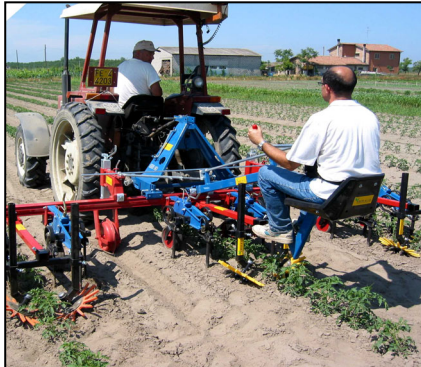
Sistema de escarda ARGUS , montaje trasero en tomate con Escardador de dedos y dirección manual
