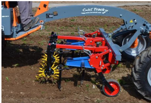
ARGUS Sistema de escarda para hortaliza 2-3 hileras con escardador de dedos para tractor portaherramientas ventral. Distancia entre hileras mín. 25 cm. Montaje delantero, trasero y entre ejes.
