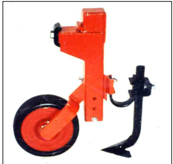
Elemento de apero telescópico con muelle y reja de pata de ganso, para distancia entre hileras a partir de 20 cm, diseño corto, ideal para montaje entre ejes
